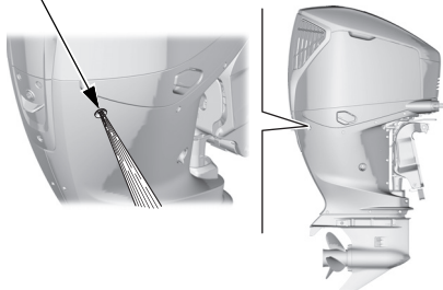
FORO DI CONTROLLO DELL'ACQUA DI RAFFREDDAMENTO
