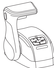
SCATOLA DEL TELECOMANDO TIPO A MONTAGGIO SUPERIORE (PER MOTORE FUORIBORDO TIPO SINGOLO)
