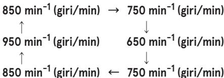
Il cicalino emette un breve suono quando la velocità del motore è impostata su 650 min<sup>-1</sup> (giri/min), indicando che è impostata la velocità di pesca a traina minima. Il cicalino emette due brevi suoni quando la velocità del motore è impostata su 950 min<sup>-1</sup> (giri/min), indicando che è impostata la velocità di pesca a traina massima.
